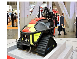
【無人走行放水ロボット】
